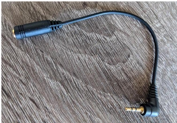
**Figure 8.** Adaptador de audio de 3 polos de 3.5mm a 2.5mm
